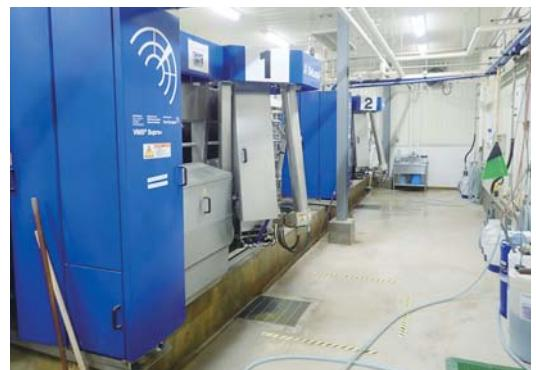
ロボット搾乳機(計8台)
