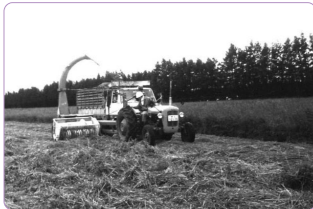
写真4. 牧草の収穫は刈り倒して予乾した後、牽引式ハーベスタで細切した。
