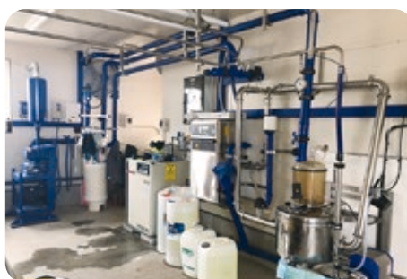
生乳のろ過装置とパイプライン
