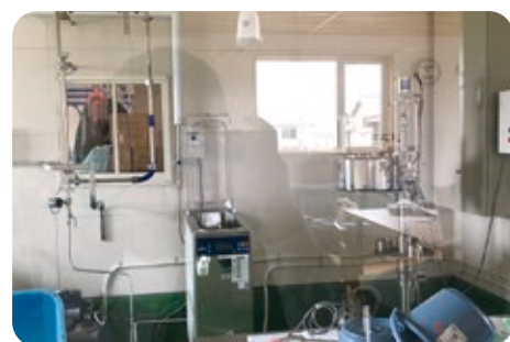
左側：パステライザー（低温殺菌装置） 右側：牛乳を樹脂ボトルに充填する充填機
