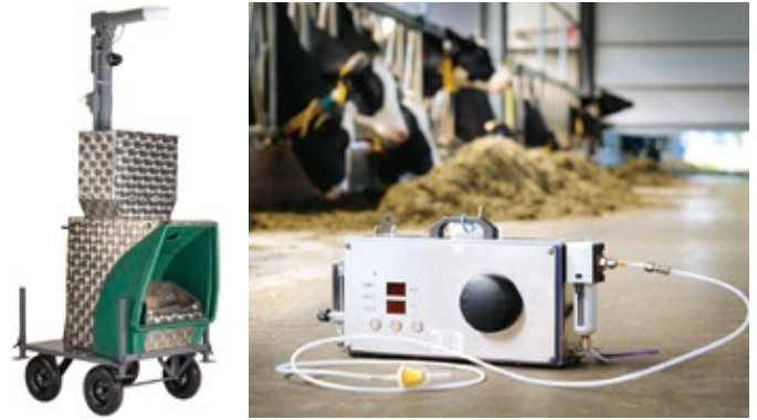
▲メタン測定器。左は米国のGreenFeed社製、自動給餌機と一体化している。右はオランダのSinffer社製、搾乳ロボットに取付可能
