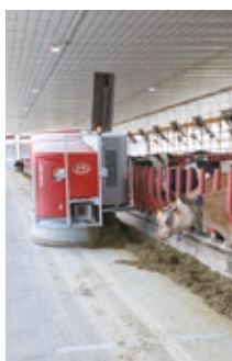
▲Pine-Tree Dairyの新しい牛舎 全自動の牛舎で搾乳ロボットは2台。給餌、飼育、除糞、換気システムや搾乳等をほぼ無人で行うICTを駆使した牛舎。 左のQRコードを読み取ると給餌の様子を動画でご覧いただけます。
